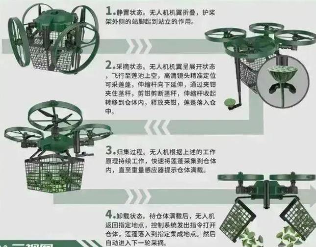
1. 静置状态。无人机机翼折叠，护桨架外侧的站脚起到站立的作用。
